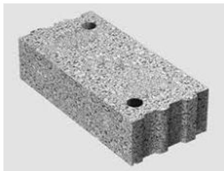
Die Druckfestigkeit dieses Steins beträgt 12,5 N/mm<sup>2</sup>, er eignet sich damit für Mauerwerk bis zur Steifestigkeitsklasse 12, egal ob für Innen- oder Außenmauerwerk. Dieser Stein kann auch unter anderen schweren Steinarten (Ziegel oder Kalksandstein) eingesetzt werden.
