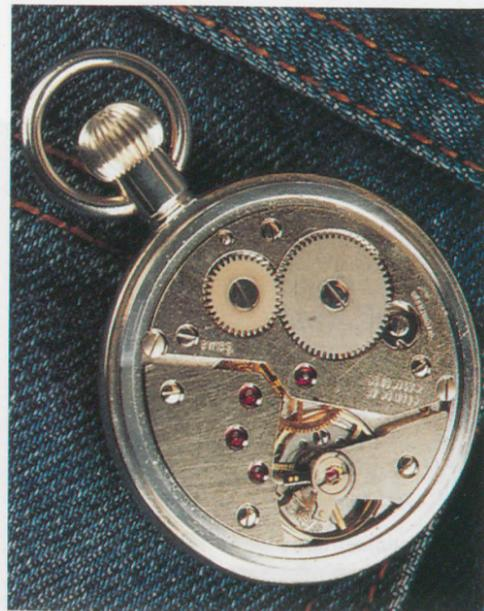
Unitas, Caliber 6498, Durchmesser 36,30 Millimeter, nicht dekoriert.
