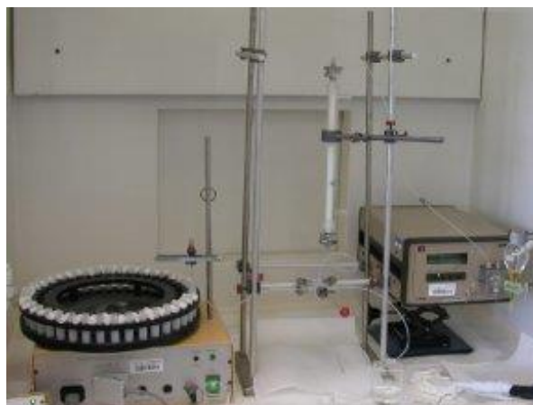
Abb. 4.6: Fotografische Darstellung der Apparatur zur chromatographischen Trennung der Actiniden.
