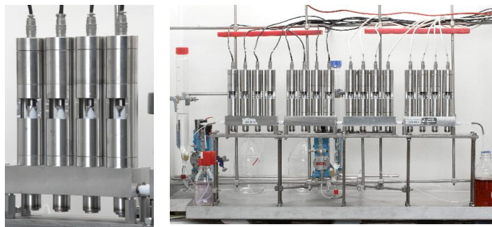
Abb. 4.5: Ausschnitt und Gesamtansicht der im Forschungszentrum Jülich zum Einsatz gekommenen Miniaturzentrifugalextraktor-Batterie.
