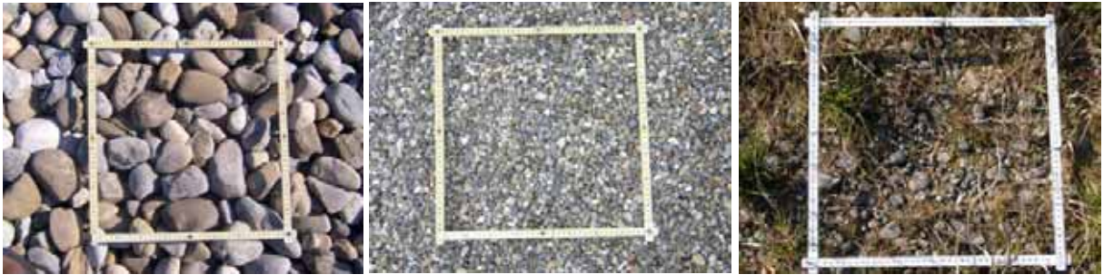
Abbildung 20: Korngrößen auf Renaturierungsfläche am Bodensee. Links: Gerölle 60/200 mm verhalten sich wasserbaulich stabil, bilden aber ein zu grobes Lückensystem, das kaum von Pflanzen und Laufkäfern besiedelt wird; Mitte: in Strandbädern wird Rollkies 20/60 mm verwendet, der durch Wellenschlag und Tritt bewegt wird, so dass sich nur eine anspruchslose Ruderalflora ansiedelt; rechts: Moräne-Material mit breitem Korngrößenspektrum bietet einer standortgemäßen Vegetation die besten Ansiedlungschancen.
