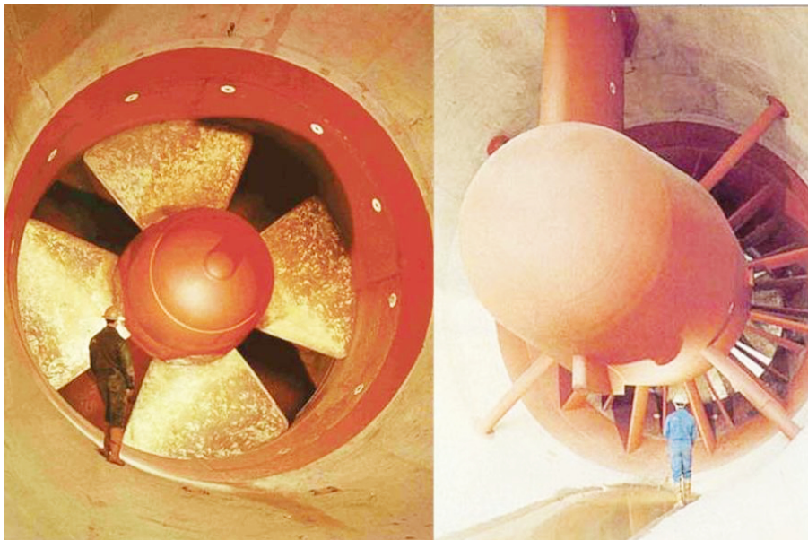
Bei einer Kaplan Turbine mit einem Durchmesser von 2.20 m, benannt nach dem österreichischen Erfinder und Entwickler Viktor Kaplan. Foto Henri Baranger
