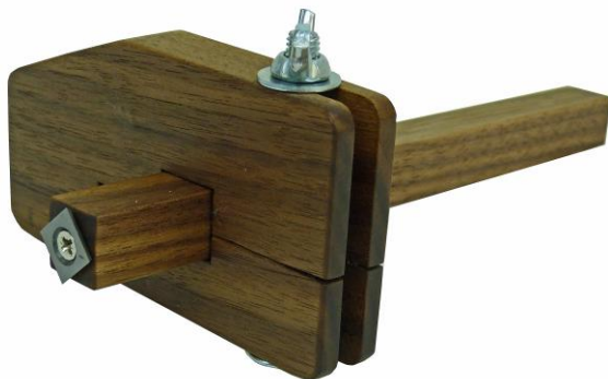
Abbildung 13: Ein selbstgebautes Streichmaß
