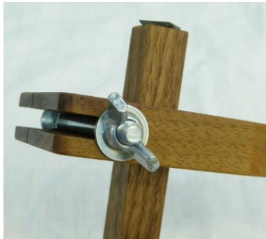
Abbildung 14: Flügelschraube als Klemmung
