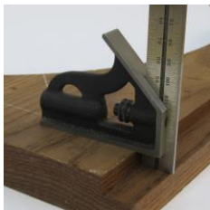
Abbildung 3: Tiefenmessen mit dem Kombinationswinkel
