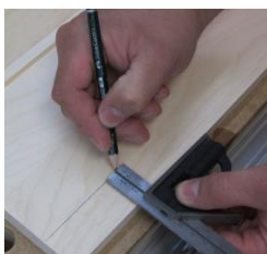
Abbildung 4: Anreißen mit dem Kombinationswinkel
