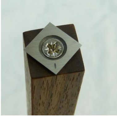
Abbildung 19: Vorschneider als Messer für das Streichmaß
