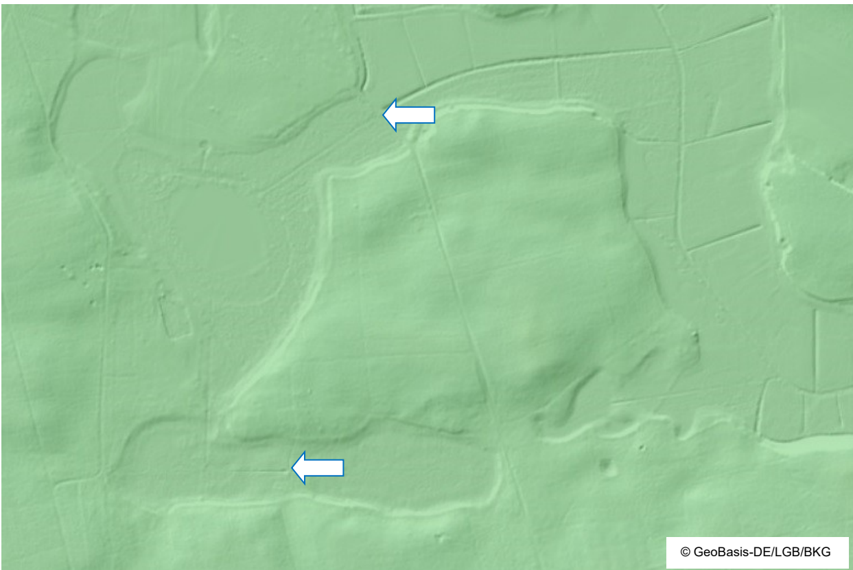
Abb. 10: Digitales Geländemodell im Bereich des Bertikower Sees. Im Bereich des nördlichen Pfeiles ist der Graben zwischen Bertikower See und Temnitz von einem Damm unterbrochen. Im Bereich des südlichen Pfeiles ist der Graben von einer Überfahrt, welche auch nicht verrohrt ist, unterbrochen.
