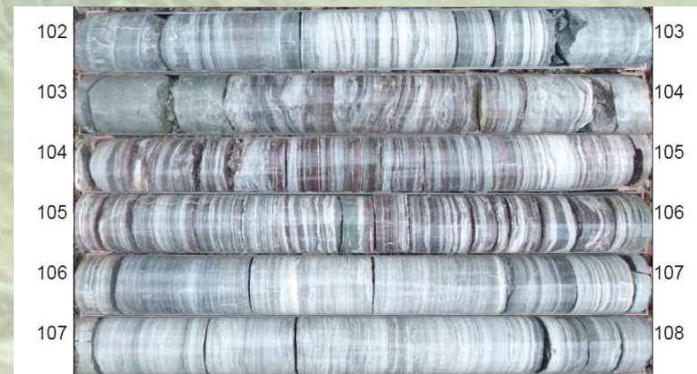
(Ausschnitt: Plattengips Grundgips-schichten)
