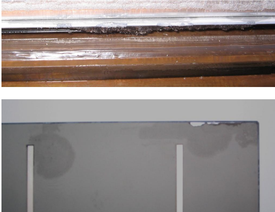
Abbildung 36: Oben: Testaufbau nach Variante III mit gewachsenen Salzkristallen; Unten: beschädigte Zellrückseite
