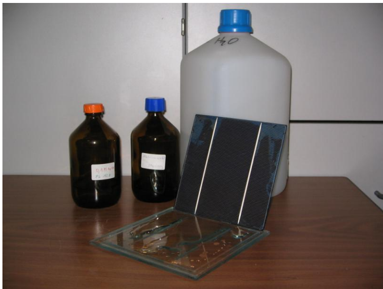
Abbildung 35: Glasplatte mit Lösung und benetztem Prüfling nach dem Stresstest
