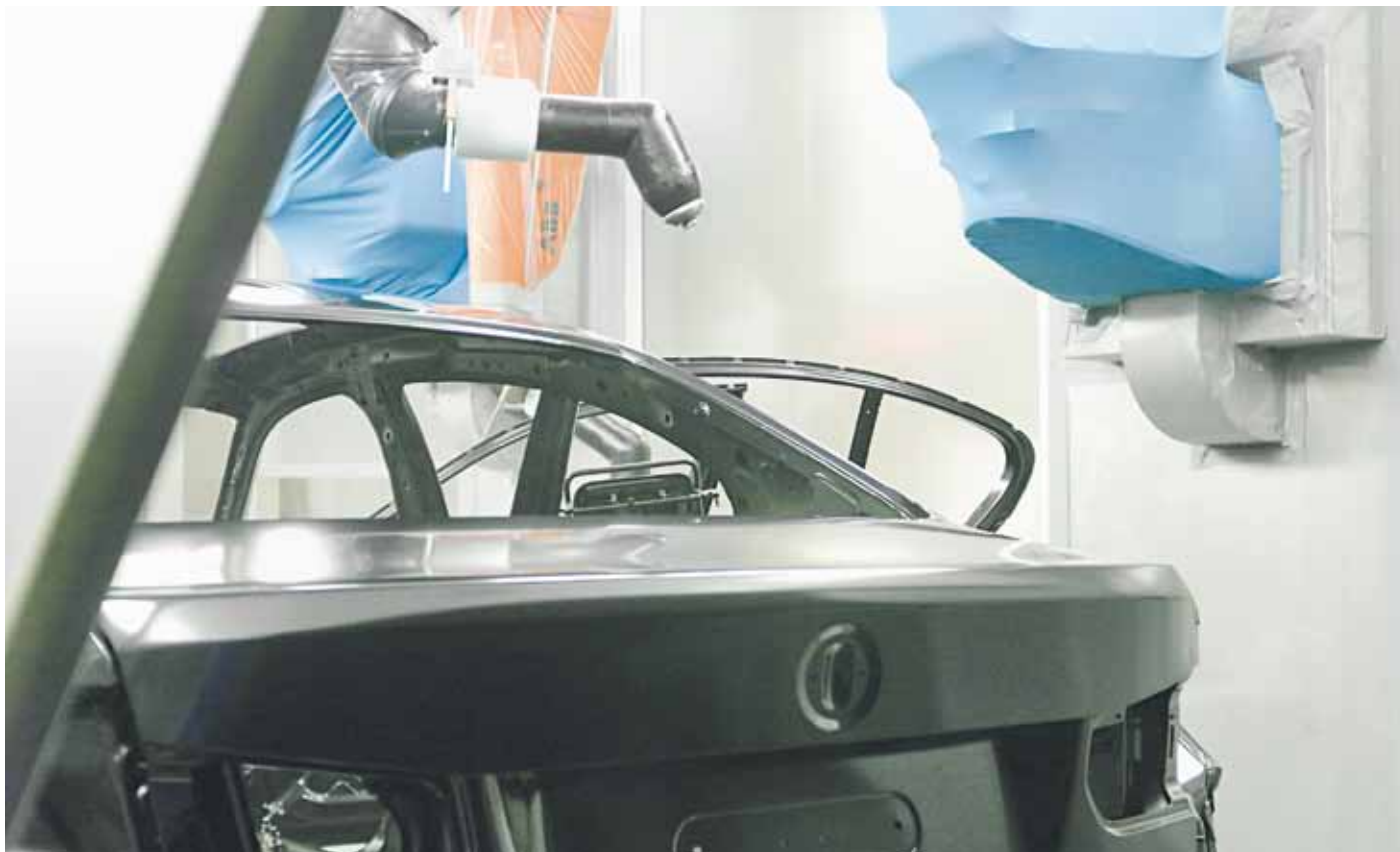
Für das Lackieren des Hecks der neuen 3er-Limousine brauchte BMW neue Lackierroboter. Sie sind an Stahlgerüsten außerhalb der Kabine montiert.
