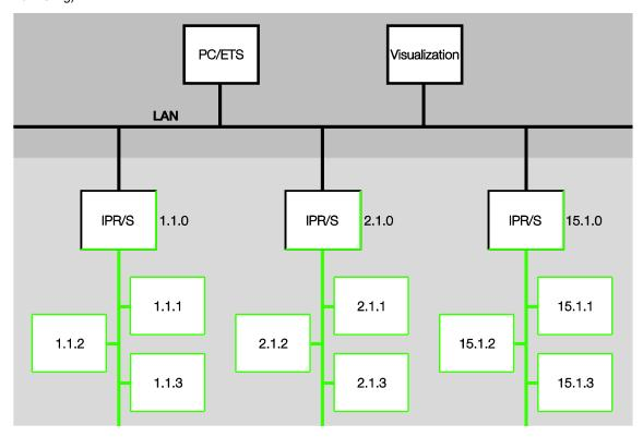
Der Router verfügt über 5 Tunneling Server, siehe Kapitel Die Verwendung der integrierten Tunneling Server, S. 38. Diese unterstützen sowohl den Busmonitor- als auch den Gruppenmonitorbetrieb (alternativ).
