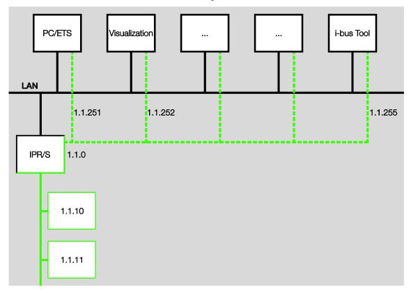
Bei Tunneling verbindet sich ein Client mit einer Buslinie. Das Tunneling-Verfahren verwendet UDP, beinhaltet aber eine Sicherungsschicht, so dass im Fehlerfall Telegramme wiederholt werden.
