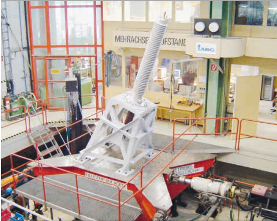
1a Seismische Prüfung einer RIP-Durchführung für 230 kV
