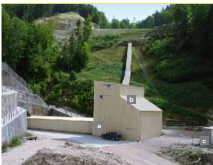
9 Beispiel einer bergab führenden Gurtförderanlage [2]
