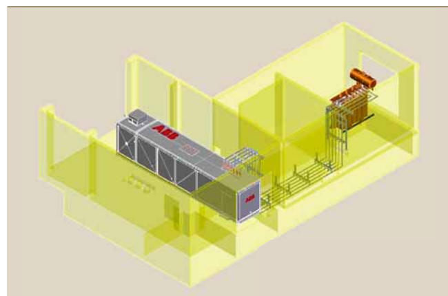
9 3-D-Modell der Installation mit 11,6-MVA-Transformator und dem Container für Stromrichter, Kühlung und Hilfssysteme
