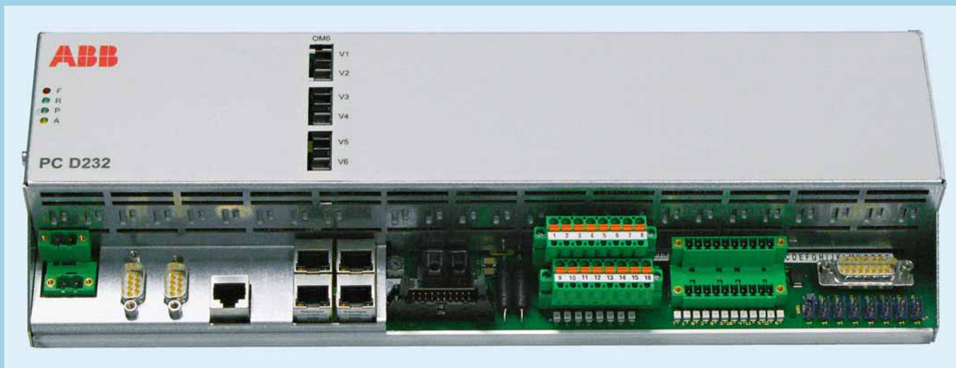
2 Typischer PP D104-basierter Controller mit integrierten E/As
