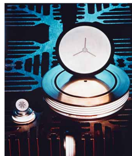
Silizium-Wafer und Gehäuse eines 1,5-Zoll- und eines 5-Zoll-Thyristors für 5,5 kV (1983)
