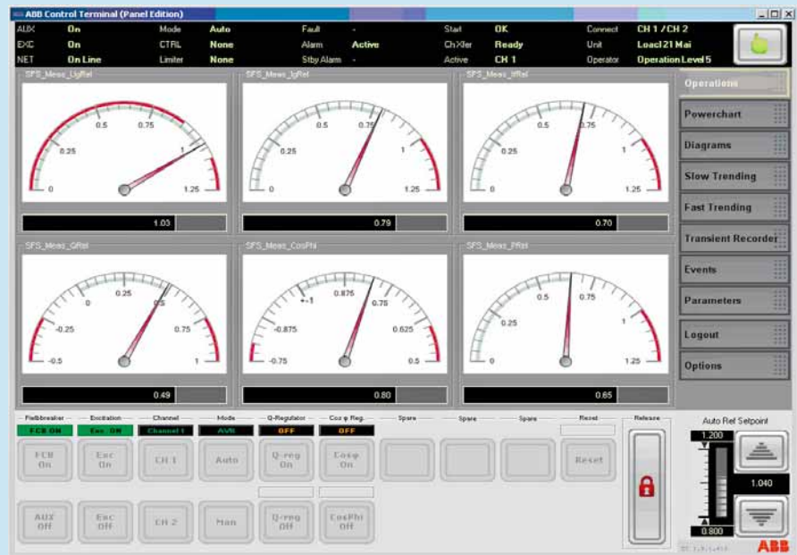
4 UNITROL 6000 Erregungssystem mit PP D104-basierten Controllern für die Stromrichter
