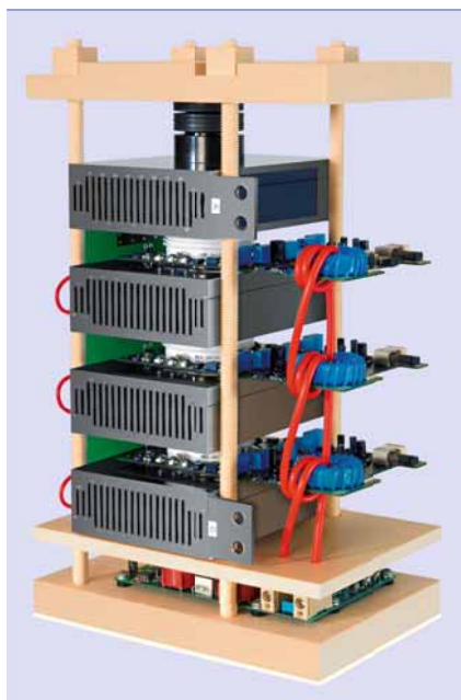
2 Schaltereinheit für das Flughafenradarsystem
