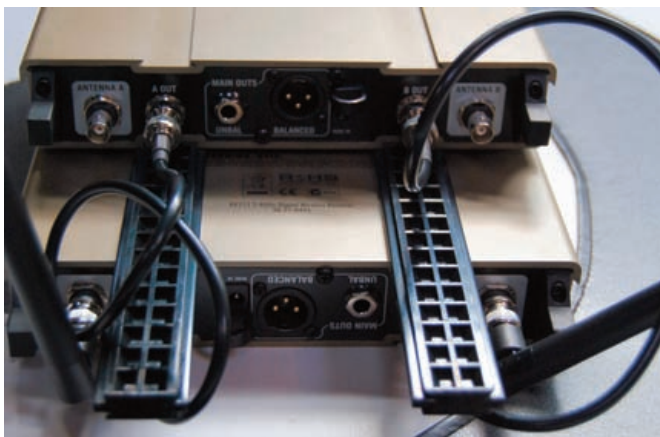
Mittels mitgelieferter Kunststoffschienen lassen sich die Line6 Empfänger sicher auf- und nebeneinander stapeln
