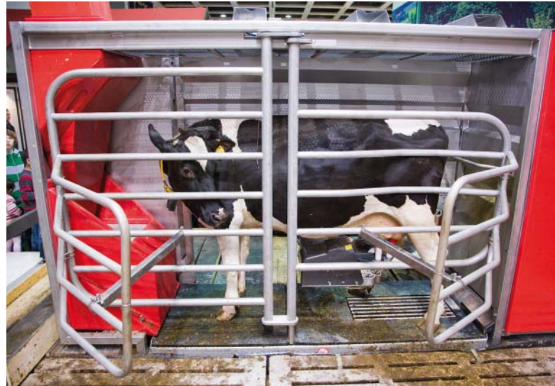
Ein Melkroboter in Aktion. Die Zitzenbecher müssen regelmäßig gereinigt werden, sonst drohen Infektionen.
