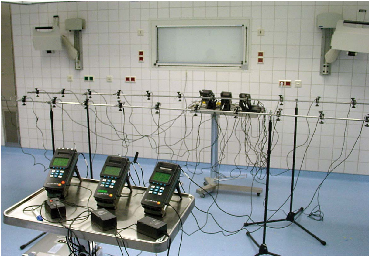
Turbulenzgradmessung im OP eines Krankenhauses.
