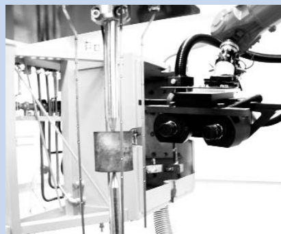
Automatische 3D-Vermessung einer deformierten Struktur
