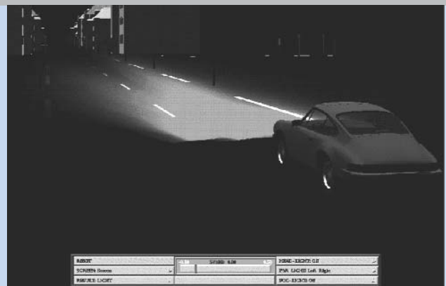
Produktoptimierung und Funktionssimulation in der virtuellen Umgebung am Beispiel der Scheinwerfertechnik
