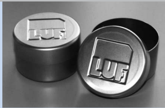
Musterwerkstücke (Multibrän Verfahren, d.h. Umformen, Prägen und Schneiden in einem Werkzeug und Arbeitsgang)
