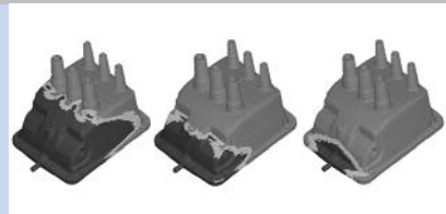
Simulation des Gelierprozesses bei der Herstellung eines Schaltergehäuses aus Epoxidharz
