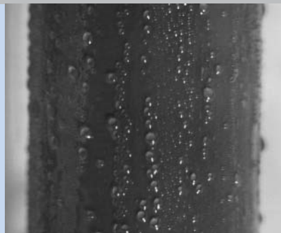
Muster der Kondensatströmung bei der Kondensation eines Benzol-Wasser-Gemisches im Bereich der Mischungslücke.
