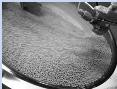
Bachelorarbeit: Herstellung von Kugeln aus Kalksteinmehl in einem Granulierteller („Agglomeration“) und Untersuchung der Prozessparameter
