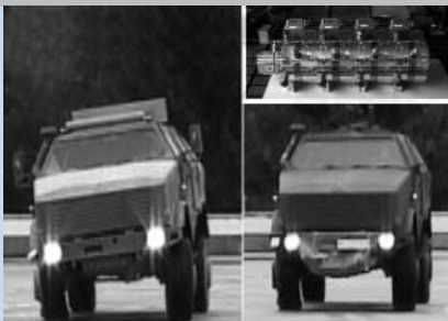
Aktives Fahrwerk in einem 12t-Geländefahrzeug; links: herkömmliches, rechts aktives Fahrwerk während Kreisfahrt; oben rechts: Flügelzellenpumpen
