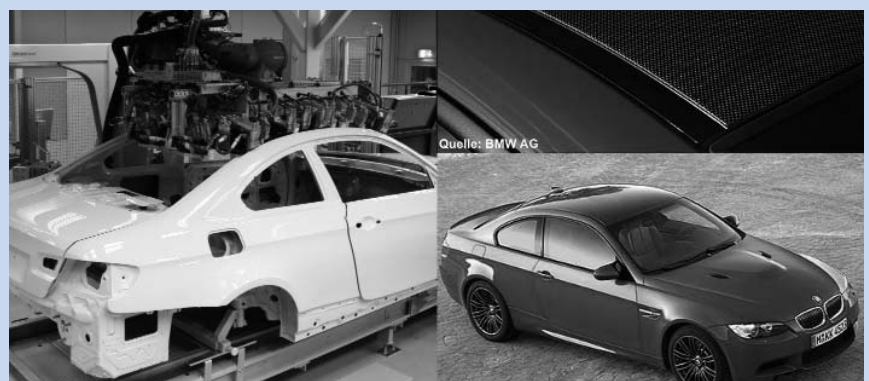
Technologietransfer in die Praxis: punktuelle induktive Erwärmung zur beschleunigten Klebstoffaushärtung des geklebten CFK-Daches des BMW-M3-Coupé
