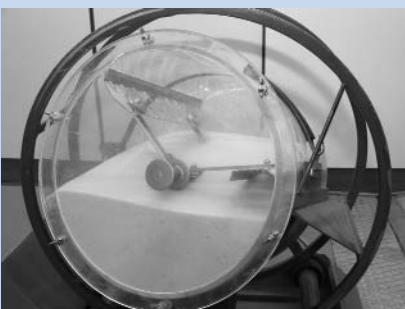
Studenten untersuchen, wie Schüttgüter in einem Rhönradmischer vermischt werden
