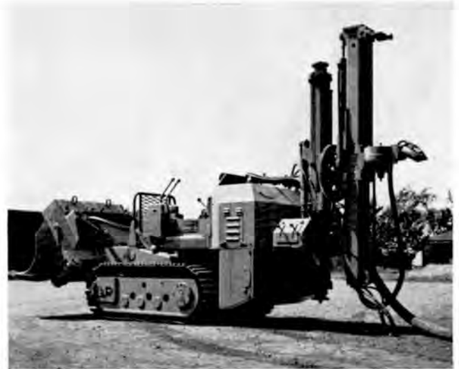
Bild 2. Der Seitenkipplader HL 180 mit der hydraulischen Drehbohrmaschine LB 21.
