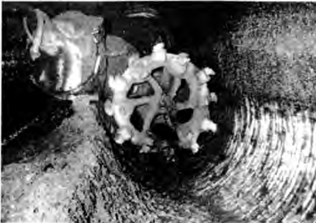
Bild 3. Aufhauenvortriebsmaschine in Flöz Anna, HS 13.0 der Zeche Zollverein (Liegendeinschnitt rd. 0,6 m).
