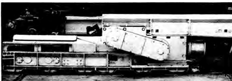
Bild 7. Schmalbauende Übergabe vom Kratzerförderer auf den Gurtförderer.
