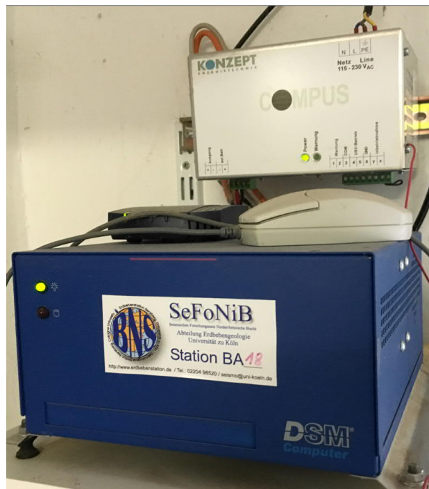
Abbildung: Seismograph der Erdbebenwarte Bensberg im Schieberhaus der Steinbachtalsperre
