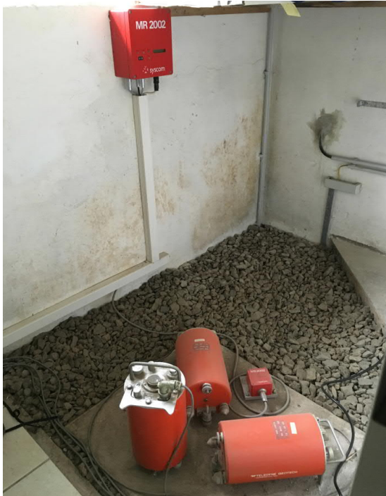
Abbildung: Seismograph der Erdbebenwarte Bensberg im Schieberhaus der Steinbachtalsperre
