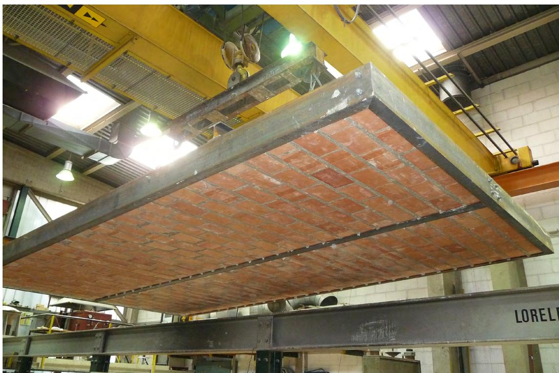
Aufbau eines Brandversuchs für eine Stahlsteindecke
