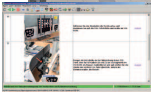
Beim VAS 6767 sind die Messwertaufnehmer mittig der Fahrzeugflanken in Bodennähe angebracht
