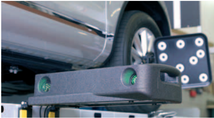
Jeder Reflektor wird von einem Beissbarth-Stereokamera-Messsystem betrachtet
