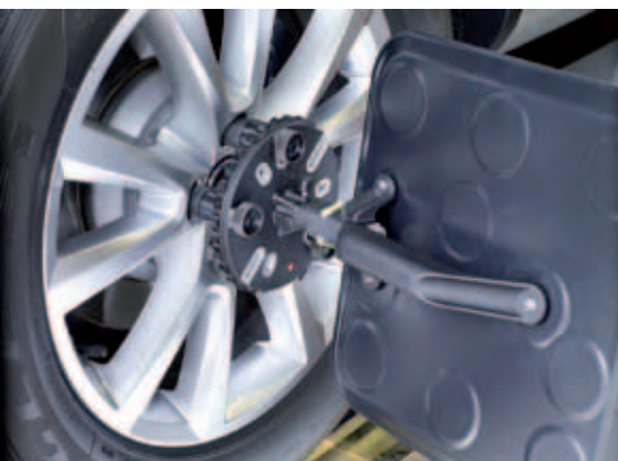
Die neuen Magnethalter beschleunigen die Fahrwerksvermessung und können die Reflektoren leicht halten
