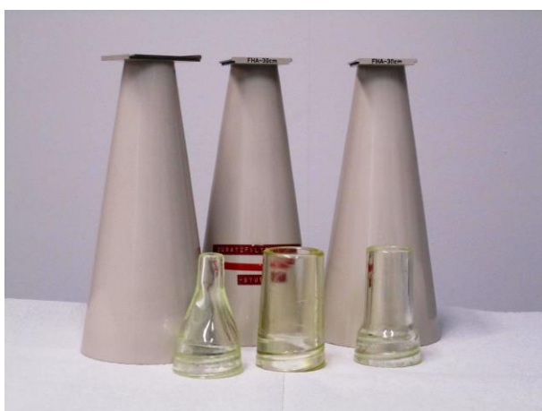
Abb. 2-3 Tubusse mit FHA 15 und 30 cm
