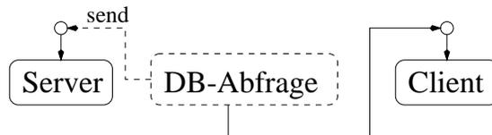
Abbildung 2: Beispiel: Client schickt Datenbank-Abfrage an entfernten Server
