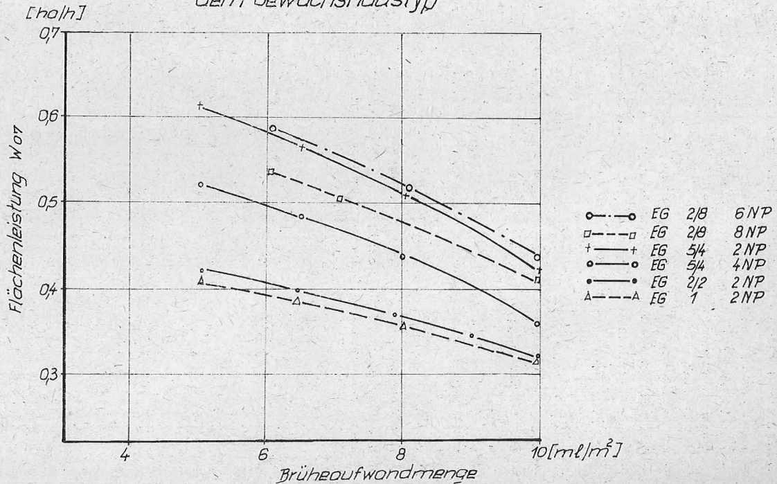
Abb. 9 Flächenleistung W_{07} beim Kaltnebeln mit KANEMA S160 in Abhängigkeit von der Brüheaufwandmenge Q und dem Gewächshaustyp
