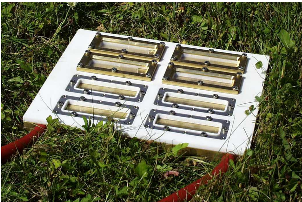
Abb. 51: Aufnahme der konstruierten Bestrahlungskammer.
