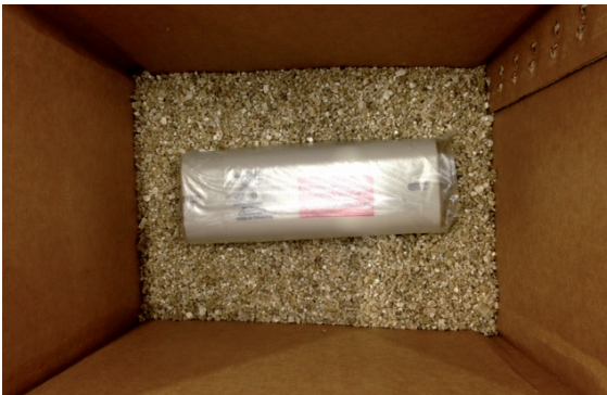
Abbildung 17: Saugfähiges Polstermaterial für beschädigte Lithium-Ionen-Batterie
