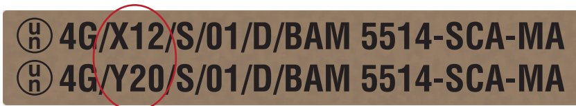
Abbildung 15: Beispiel für die Kennzeichnung von Gefahrgutverpackungen, die für Lithium-Ionen-Batterien zulässig sind
