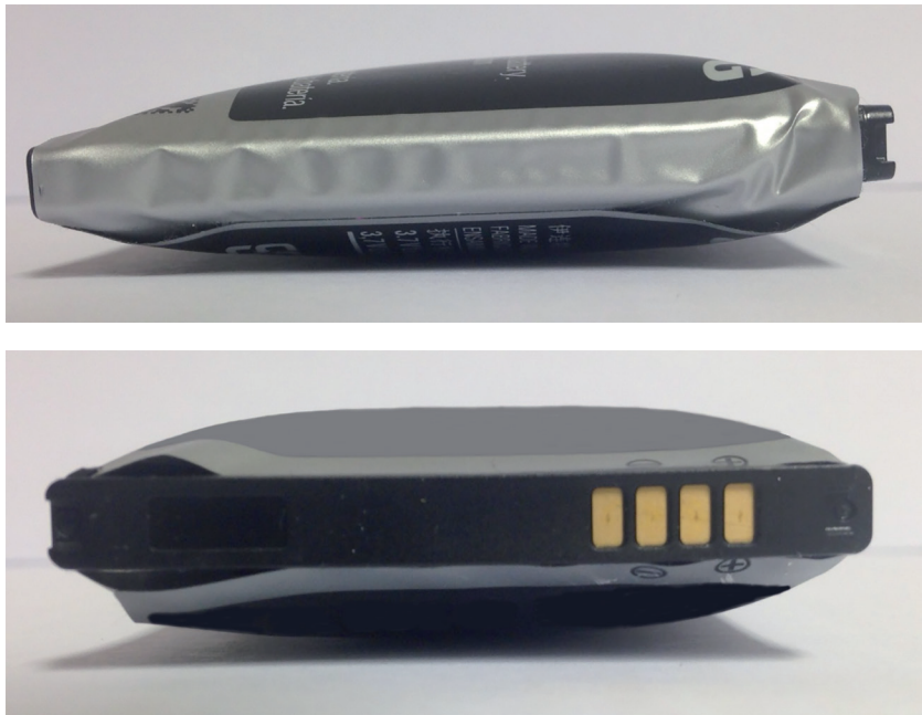
Abbildung 13: Diese Lithium-Ionen-Batterie ist ausgegast aber zum Glück nicht explodiert und in Flammen aufgegangen
