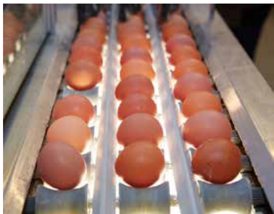
◆ Die Eier werden im Lichttunnel auf Haarrisse und Schwachpunkte in der Schale überprüft
