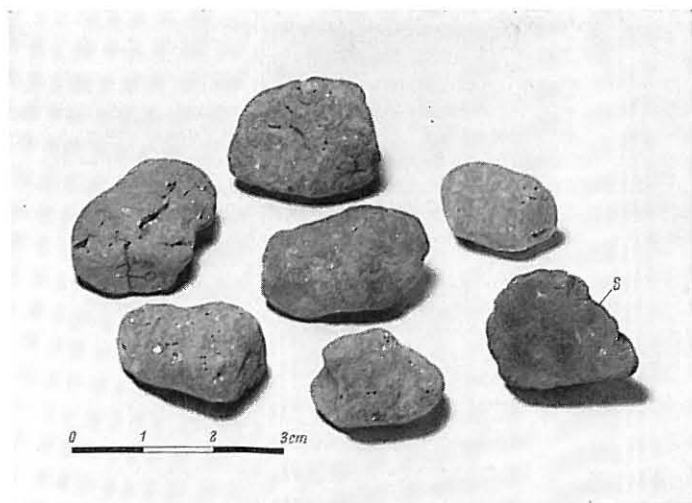
Bild 8 b Blähtonzuschlag „Idealite“ der Idealite Company, Denver; im Drehofen gebrannter Schieferlon; Korngruppe 9,5/25 mm. Betondruckfestigkeiten von rd. 500 kp/cm 2 mit etwa 350 kg/m 3 Zement bei einer Rohdichte von etwa 1,50 kg/dm 3 . Rechts unten Schnitt S durch ein Zuschlagkorn
