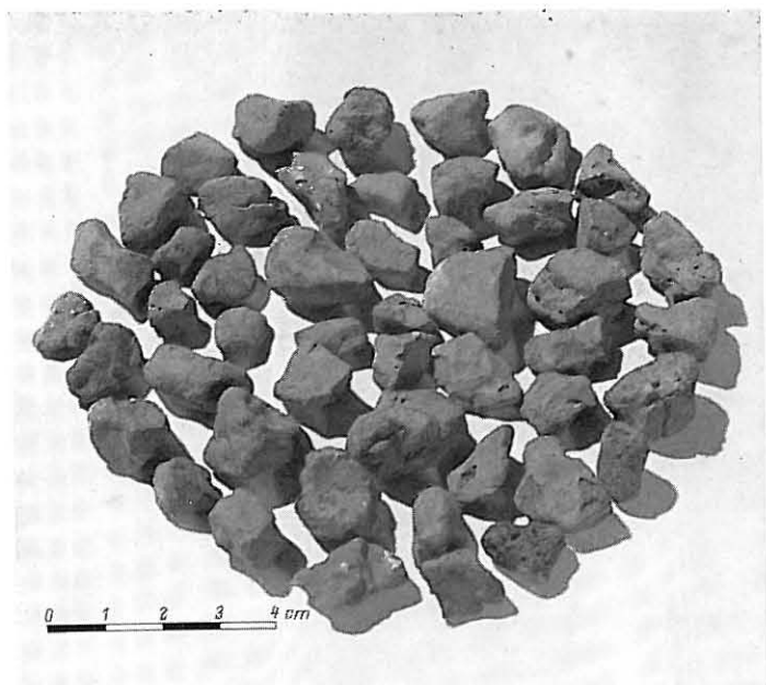
Bild 8 a Blähtonzuschlag „Materialite“ der Material Service Company, Chicago; im Drehofen gebrannter Schieferlon; Korngruppe 9,5/19 mm. Betondruckfestigkeiten von rd. 500 kp/cm 2 mit etwa 390 kg/m 3 PZ I bei einer Rohdichte von etwa 1,55 kg/dm 3 (Photo J. J. Shideler)
