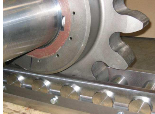
Abbildung 38: Triebstockantrieb Quelle: < http://www.henkenjohann.de/de/produktpalette_sonderanfertigung/triebstock/ >, 21.09.2015)
