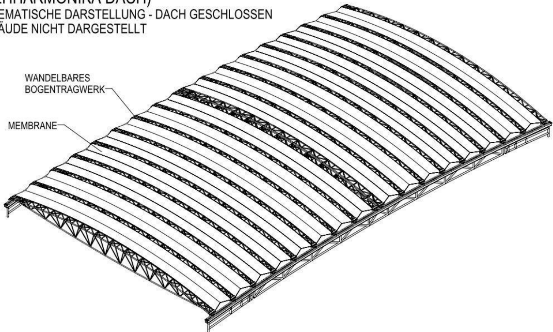
Abbildung 77: Ziehharmonika Dach - geschlossen
