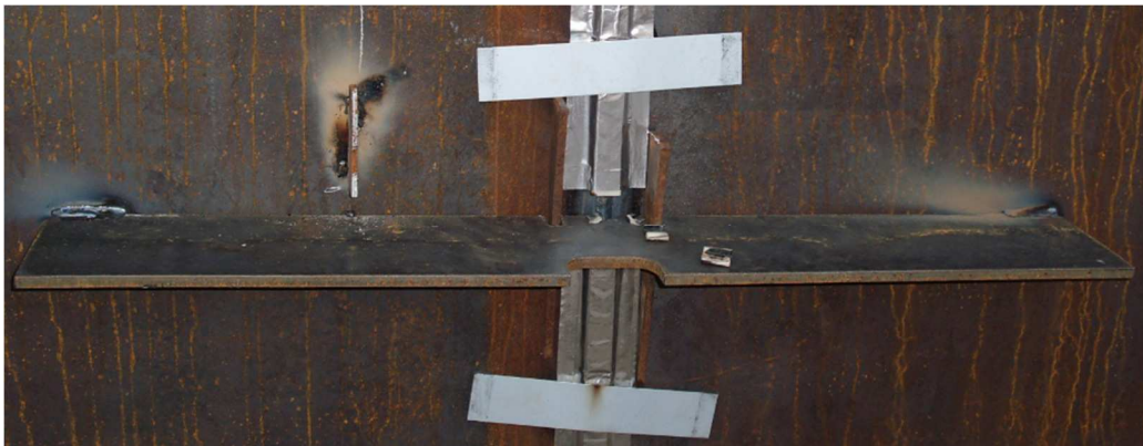
Abbildung 18: Radiusblech mit Schweißkeramik an Stehnaht
