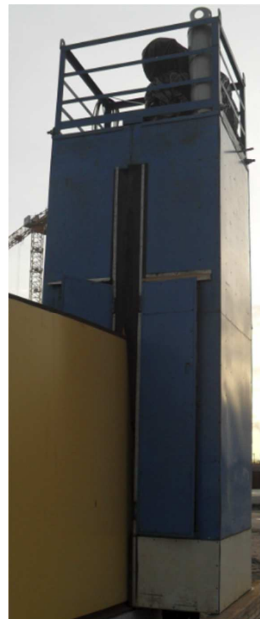
Abbildung 12: einteiliger verblechter Schweißerkorb
