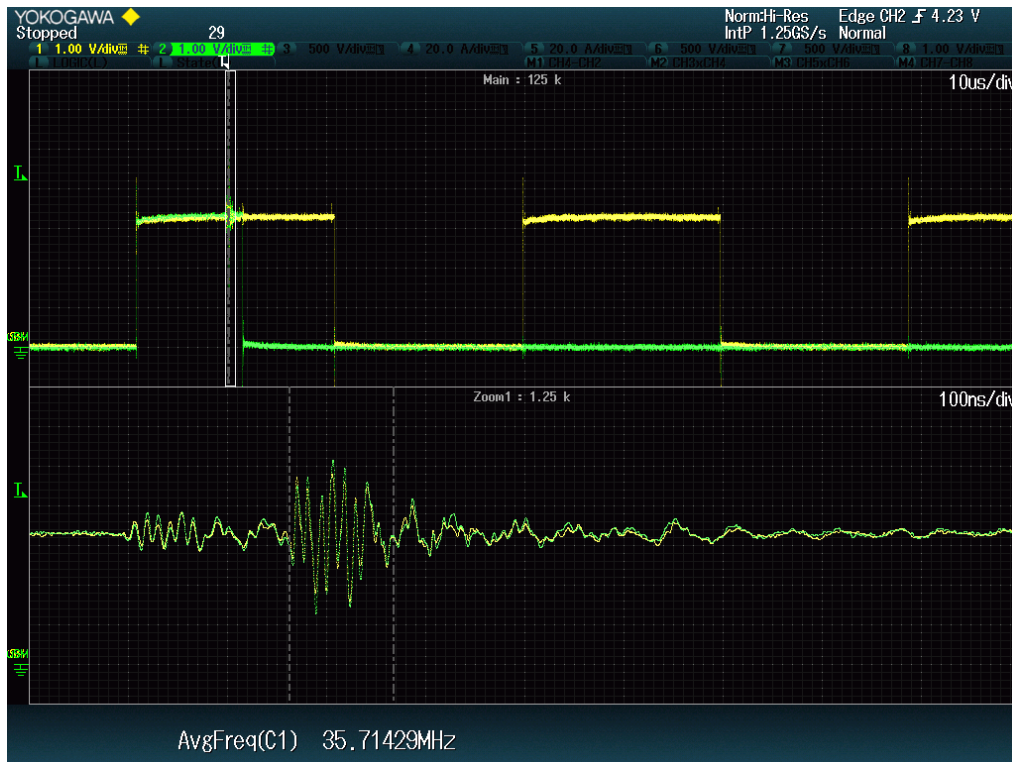
Abbildung 3.5: Störeinkopplung nach NAND-Gatter
