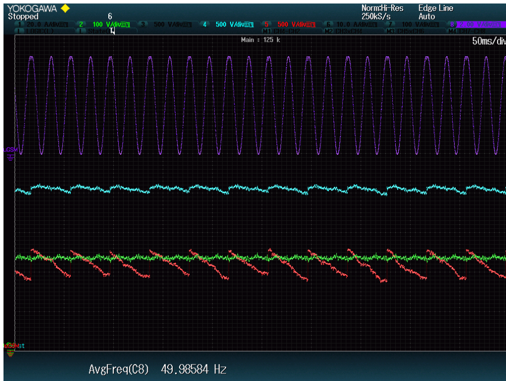
Abbildung 3.6: d und q-Anteil der Ständerspannung ohne software Filter
