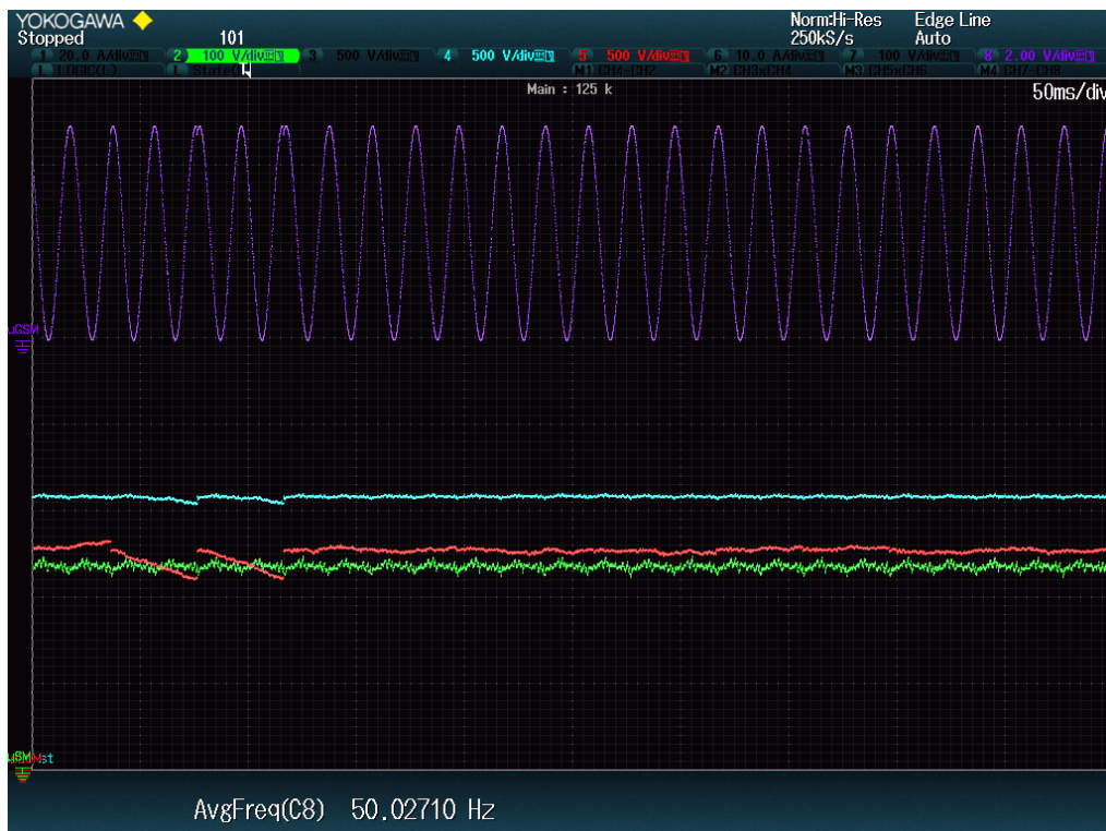
Abbildung 3.7: d und q-Anteil der Ständerspannung mit software Filter
