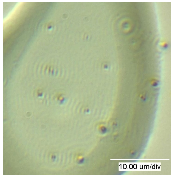
Abbildung 8: vereinzelte Ripple-Strukturen nach einem Puls auf ta-C Schicht
