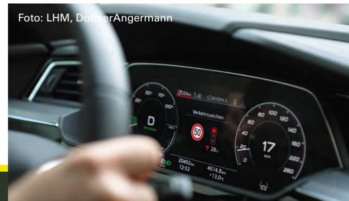
Anzeige Countdown Ampelprognose bis zur Umschaltung auf grün
