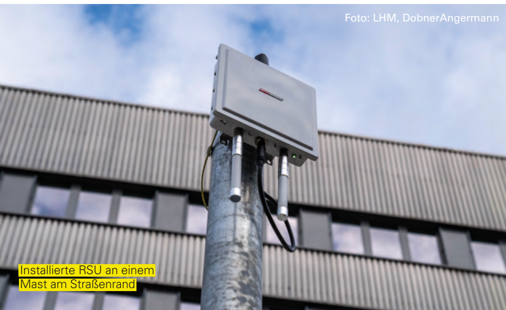
Übermittlung der Kreuzungstopologie und Signalphasen ins Fahrzeug
