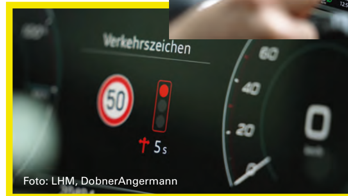
Anzeige Countdown Ampelprognose bis zur Umschaltung auf grün
