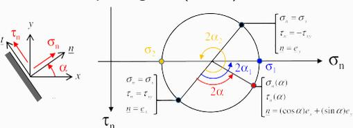
Bemerkung: Positive Normalspannungen (Zug,  $\sigma > 0$ ) wirken in Richtung der Flächennormale  $\underline{n}$
