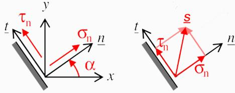
Der Körper wird geschnitten, der Spannungsvektor  $\underline{s}$  wird in die Normalspannung  $\sigma_n$  und die Schubspannung  $\tau$  geteilt.
