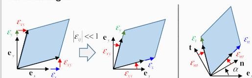
$$\begin{aligned} \epsilon_x & \text{ Dehnung in } x\text{-Richtung} & +: \text{Dehnung, } -: \text{Kürzung} \\ \epsilon_{xy} & \text{ Schubverzerrung} & +: \text{Winkelverkleinerung, } -: \text{Winkelvergrößerung} \\ \gamma_{xy} &= 2 \cdot \epsilon_{xy} & \text{Schubwinkel} \end{aligned}$$
