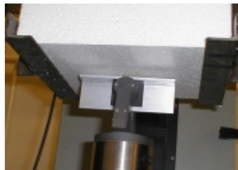
Abbildung 32: Ausziehverhalten eines stiftförmigen Befestigungselementes mit widerhakenartigen Aufsetzen.
