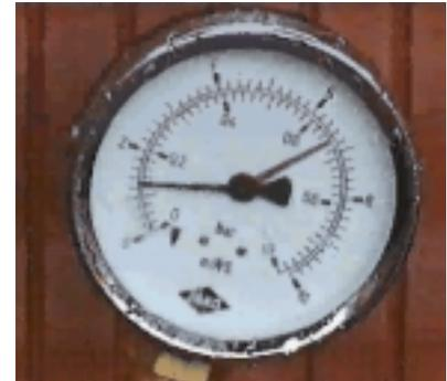
Abbildung 44: Versuchsaufbau und Meßapparatur; Meßbereich des verwendeten Manometers 1 bar.
