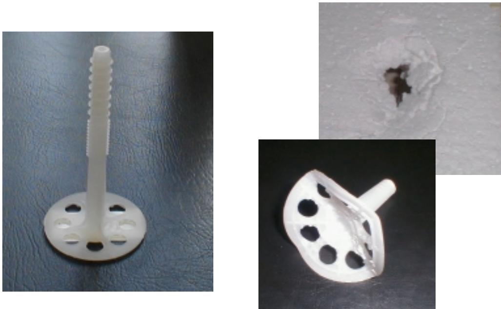
Abbildung 29: Herkömmlicher Tellerdübel und Bruchverhalten beim Auszug aus einer 10 cm starken EPS-F-Platte.
