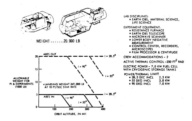
Figure 1-11. Sortie Lab Capabilities
