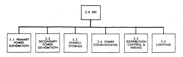
Figure 26. Electrical Power Subsystem (EPS)
