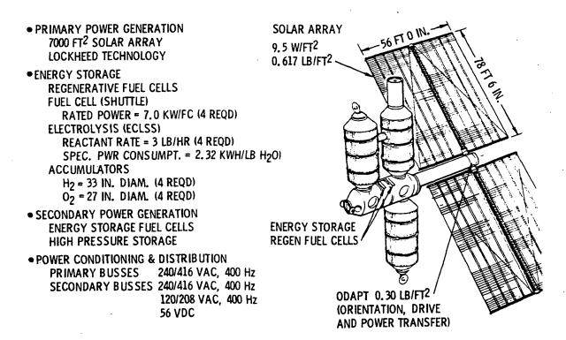
Figure 27. EPS Concept Selection - 14-Foot Phase B
