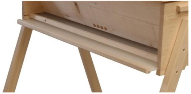
Das Lochblech erstreckt sich über die ganze Bodenfläche. Die Inspektionsluke auf der Rückseite der Beute bleibt erhalten. Sie liegt mit der Unterkante auf der Leiste der Lochblechschublade auf. Im Normalfall bleibt die Lochblechschublade immer geschlossen und ist an der Vorderkante mit zwei Schrauben von unten am Korpus angeschraubt.
