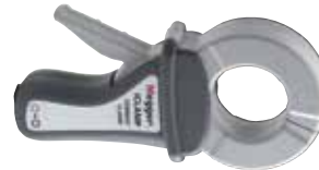
1001-012 (ICLAMP) Stromzange (Öffnung 54 mm) zur Messung von Leck- und Ableitströmen von 0,1 mA bis max. 200 A, sowie als Messzange zur selektiven bzw. zur spießlosen Erdungsmessung induzierende Stromzange
