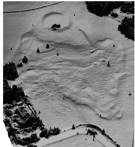
Abb. 10: Rutschung mit Lockermaterialcharakter in stark verwitterten, veränderlich festen Gesteinen der Grestener Klippenzone (JOCHUM et al., 2008); linkes Bild: Kartierung auf Orthofotobasis; rechtes Bild: Laserscan (DOM) des zentralen Rutschungsbereichs.
