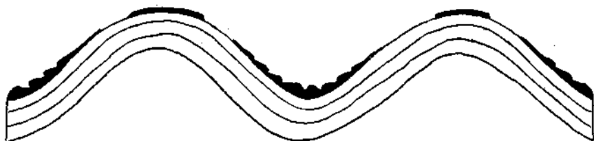
Fig. 19. Lokale Gleitungen an den Gewölbesflanken.
