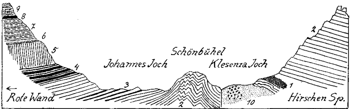
Fig. 27. 1 = Rauhwacke. 2 = Hauptdolomit. 3 = Plattenkalk. 4 = Kössener Schichten. 5 = Oberrätalkalke. 6 = Bunte Liaskalke. 7 = Fleckenmergel. 8 = Grüne und rote Horsteinkalke. 9 = Aptychenkalke. 10 = Sandsteine und Mergel mit Blöcken von glasgrünen Glaukonitsandsteinen, bunte Breccien . . .
