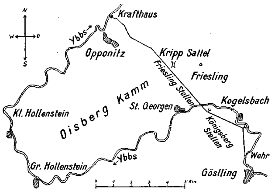
Fig. 32. Schematische Karte des Verlaufes der Stollen des Ybbstalwerkes.
