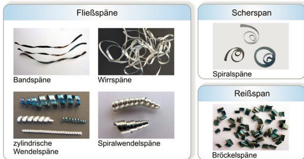
Abb. 11: Spanformen geordnet nach den Spanarten; Quelle: Werkzeugmaschinen Aufbau, Funktion und Anwendung vonspanenden und abtragenden Werkzeugmaschinen, Springer
