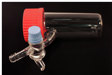
Abbildung 29: Miniatur-Vakuumkammer für die elektrochemische Zelle.
