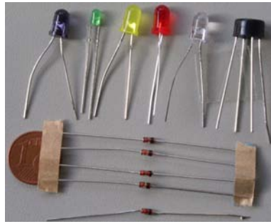
Abbildung 6.5: Beispiele für verschiedene Dioden: links IR-Diode, daneben vier verschiedenen LEDs, unten Gleichrichterdiode und eine Zenerdiode. Das Bauteil rechts ist ein integrierter Brückengleichrichter – zu verwenden an Stelle des Viererpacks Gleichrichterdiode
