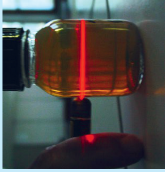
Test auf Silber-Nanopartikel mit dem Laserpointer
