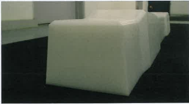
Abb. 3: Kunststoffprototyp der Bahnschwelle im Maßstab 3:4
