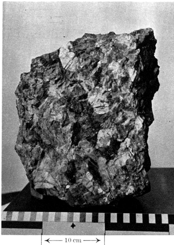
Fig. 5. Derselbe Block wie Fig. 4. Gross-spätiger Schrättkalk mit bis 5 cm grossen Kalkspatkörnern. Dazwischen Nester und Infiltrationen von Kohle (schwarz bis dunkelgrau).
