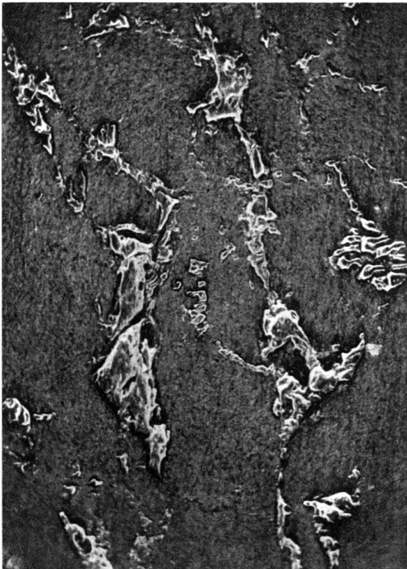
Fig. 3. Anshl., 14:1. Brackwasserkalk, Abbau-Feld Dx-10 über Grundstrecke II-S, Kote 1808. Kalkige, kohligh durchstäubte Grundsubstanz mit Nestern und tropfenartigen Einschlüssen von Kohle (Randreflexe).
