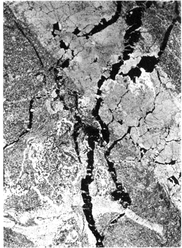
Fig. 2. Dünnschl., 10:1. Brackwasserkalk, Einschluss in der Kohle der Hauptkluft, Schacht Cornu, Kote 1755. Calcitgang von Kohle durchsetzt. Rissbildungen durch Kohle verheilt.
