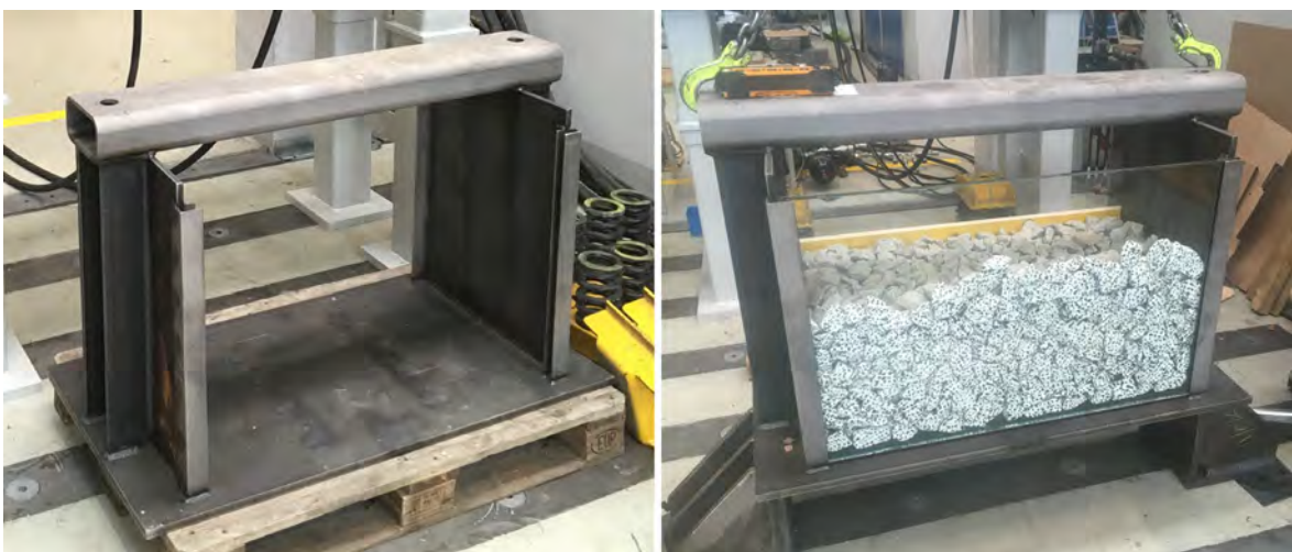
Abbildung 3.2: Leerer Stahltrug (links) und teilweise befüllter Versuchskörper (rechts)
