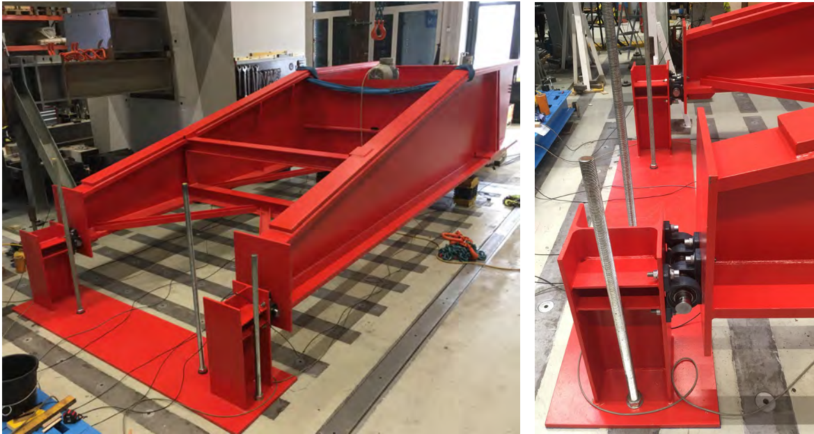
Abbildung 4.12: Aufgebauter Stahltrog auf Federpaketen (links) und Auflagerdrehpunkt (rechts)
