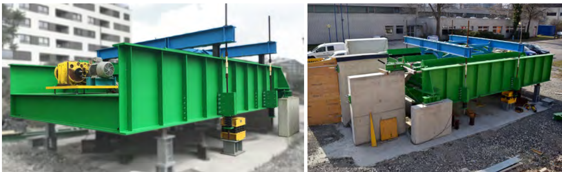
Abbildung 1.1: Großmaßstäbliche Versuchsanlage der Vorgängerprojekte „ Schotteroberbaumod. “ ([1], FFG-Projektnr. 840545) und „ Schotteroberbaukennw. “ ([2], FFG-Projektnr. 850537)
