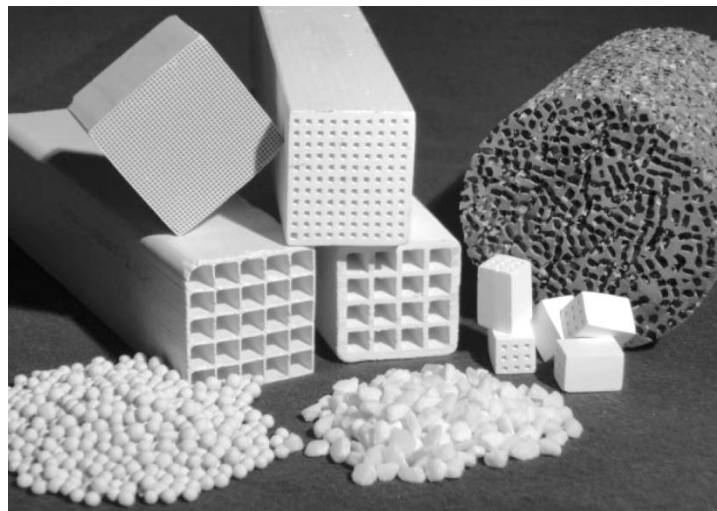
Abb. 4-27 Verschiedene Trägerstrukturen [Kerskes]
