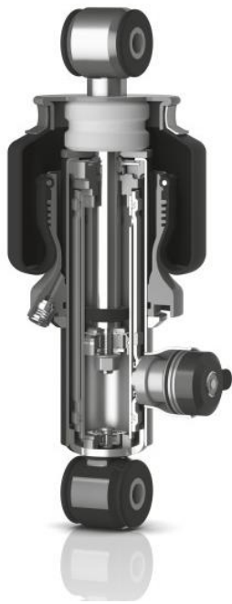
Abbildung 25 ZF Sachs: elektronisch geregeltes Dämpfungssystem CDC® - Continuous Damping Control (ZF 2016_08)
