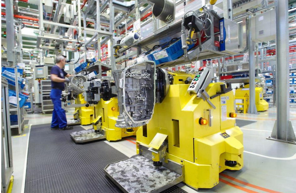
Abbildung 21 Getriebemontage am Standort Saarbrücken (ZF 2016_04)
