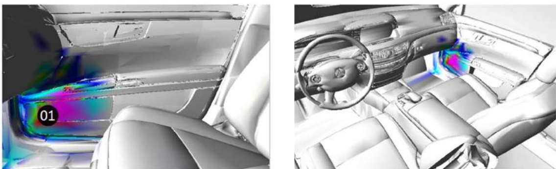
Abb. 10.9: Dreidimensionale Schalldruckkartierung im Fahrzeuginnenraum bei Anregung über einzelne Impulse an Position 01 (links), und in einer Übersicht (rechts)
