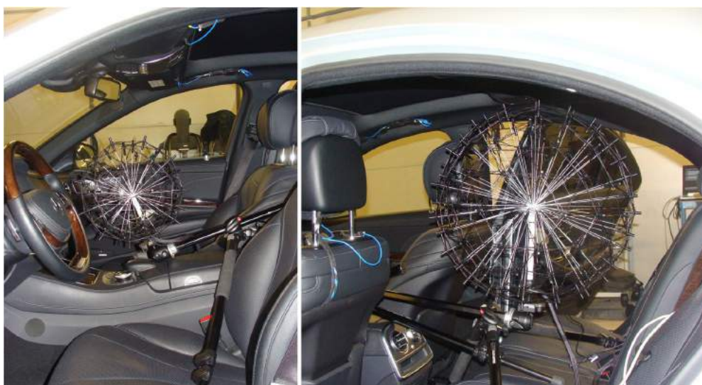
Abb. 9.10: Exemplarische Messkonfiguration mit zwei offenen, sphärischen Mikrofonarrays im Fahrzeuginnenraum
