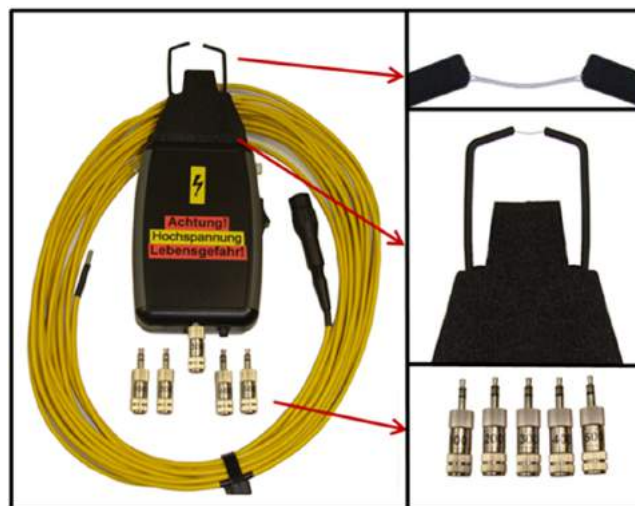
Abb. 10.2: Modifizierter Elektroschocker und ansteckbare Widerstände
