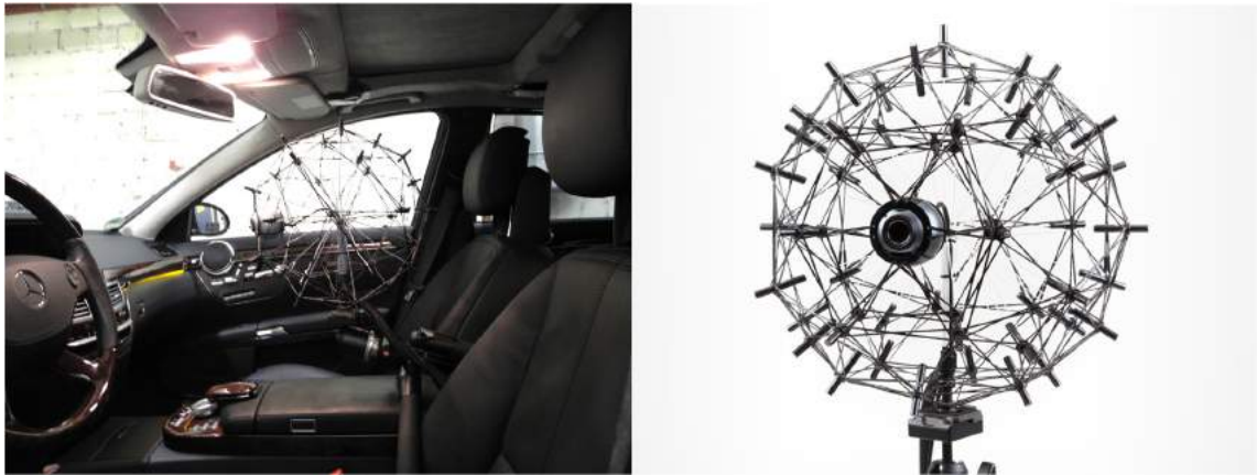
Abb. 7.11: Untersuchungsaufbau im Fahrzeuginnenraum (links), verwendetes 48 Kanal Mikrofonarray (rechts)
