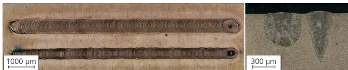
Bild 25: Nahtberraupe und Nahtquerschnitt beim Laserstrahl- schweißen mit örtli- cher Leistungsmodu- lation (oben, links) und ohne Modula- tion (unten, rechts) auf CuSn6
